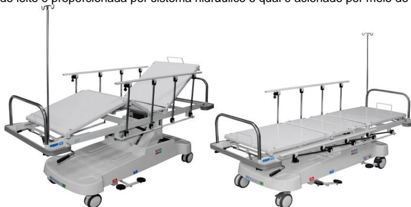
**ESTRUTURA TUBULARES , LEITO E BASE:** quadro do leito e estruturas confeccionadas em aço tubular quadrados de 30 x 30 x 1,5mm; e base com tubos retangulares 30 x 50 x 1, 5mm e 3mm, recebendo proteção por carenagem em fiberglass.
