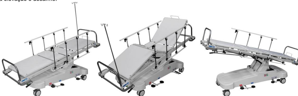
**RODÍZIOS:** este equipamento é fornecido com rodízios com diâmetro de 5" com sistema de freios em diagonal, com banda de rodagem dupla com faixa em PU de alta resistência, dotados de rolamentos blindados que proporcionam leveza na locomoção da maca, baixo índice de ruídos e menor esforço do operador;
